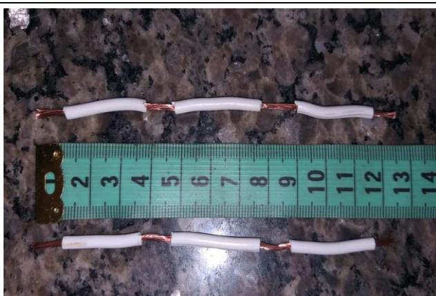
Com o alicate, separe o fio com medida de 24 centímetros e descasque as quatro pontas dos fios que agora medem, aproximadamente 12 centímetros. Descasque o fio com medida de 4 centímetros a partir de suas extremidades. Monte a ligação em paralelo colando, com a fita isolante, as pilhas nas extremidades do fio.'
