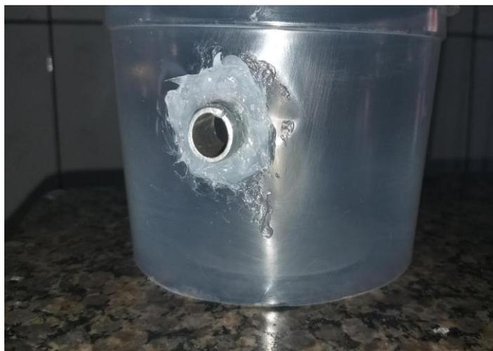
Passe a cola, de modo a não deixar a água vaziar em alguma ruptura da junção recipiente com bico de torneira.
