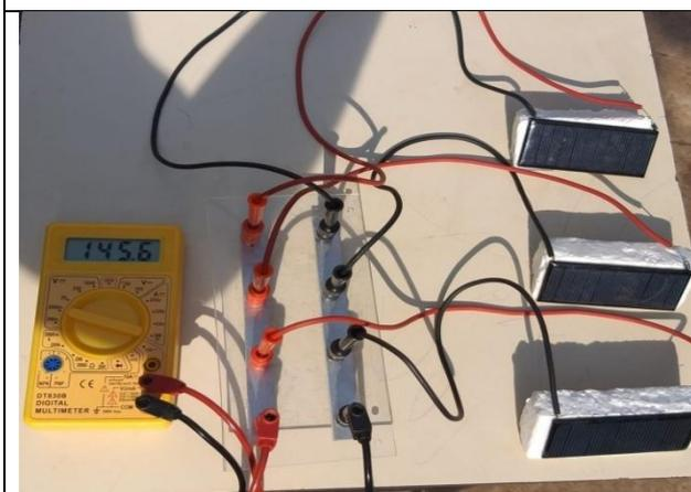
A corrente elétrica é proporcional ao número de células solares, totalizando 145,6 ampères, comprovando a propriedade da ligação em paralelo para geradores.
