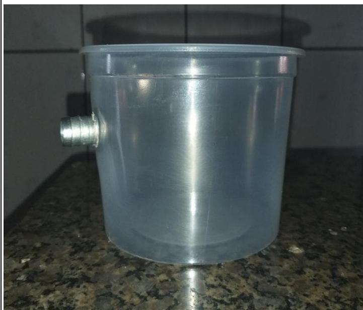
Encaixe, de dentro para fora, os bicos de torneira aos furos dos recipientes, em seguida passe cola de silicone ao redor de sua base fixando os bicos nos recipientes.
